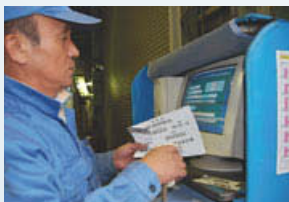
製造ラインでは、パソコンに示されたスケジュールをベースに作業を行う(上)。作業の前後に時刻を入力し(左)、想定ポイント(時間)と実績時間との比較・調整も行っている
